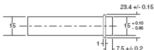
Рис. 9. Конец трубы для соединения с уплотнительным кольцом
