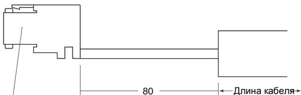
3-контактный соединитель RAST 5
