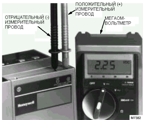
Рисунок 12. Измерение напряжение сигнала пламени в управляющих устройствах 7800 SERIES
