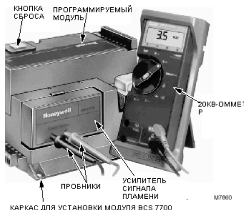
Рисунок 13. Измерение напряжения сигнала пламени BCS 7700
