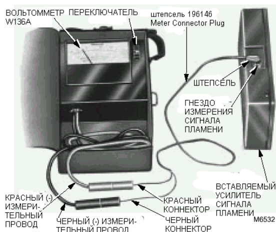
Рисунок 11. Измерение сигнала пламени в мкА
