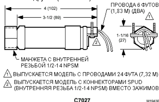
Рисунок 1. Установочные размеры C7027A, дюймы (мм)
