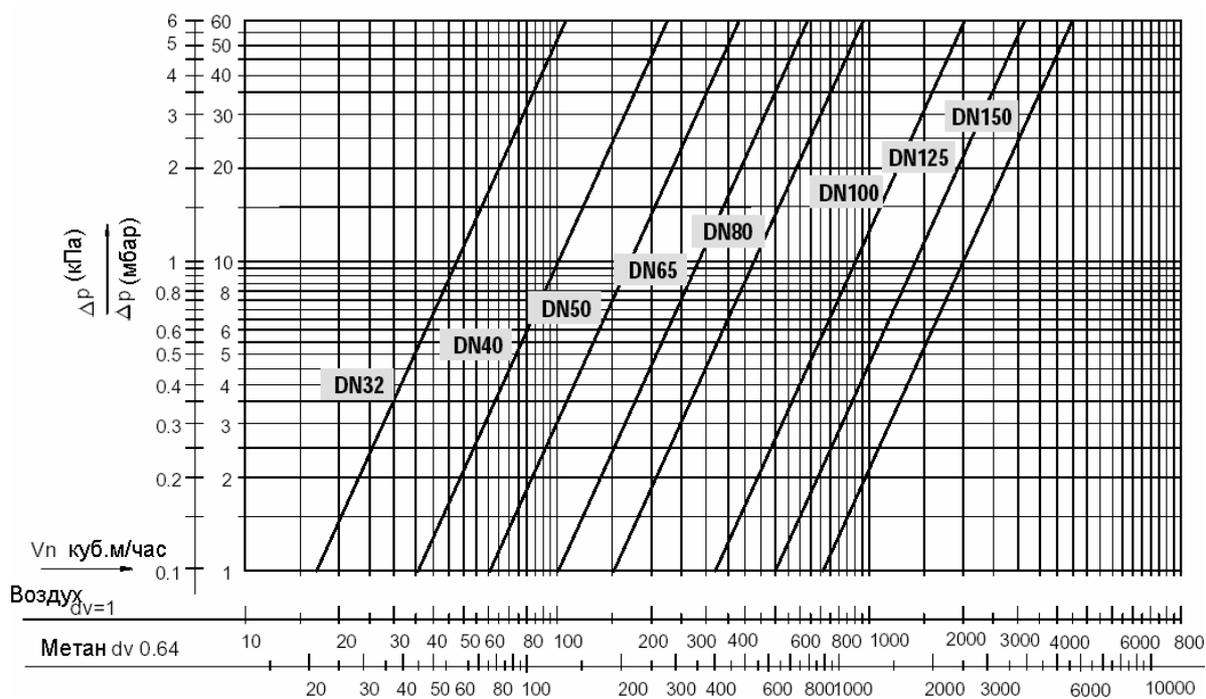
Рис. 38 Пропускная способность VF5000R Серии с пониженной производительностью
