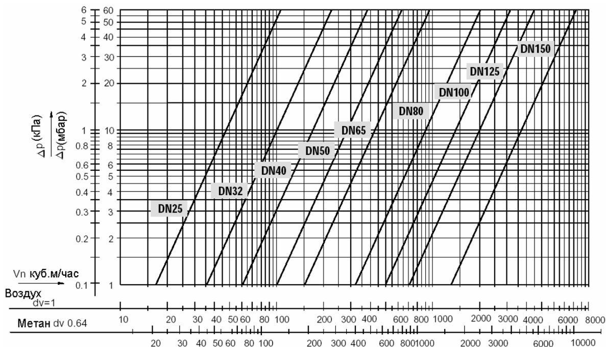
Рис. 37 Пропускная способность VF5000A Серии
