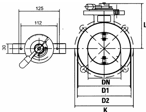
Рис. 22 Размеры VF5000A3/R3
