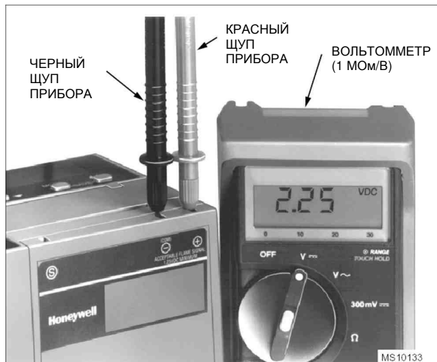
Рис. 11. Измерение сигнала пламени (сигнала напряжения) на блоке управления серии 7800
