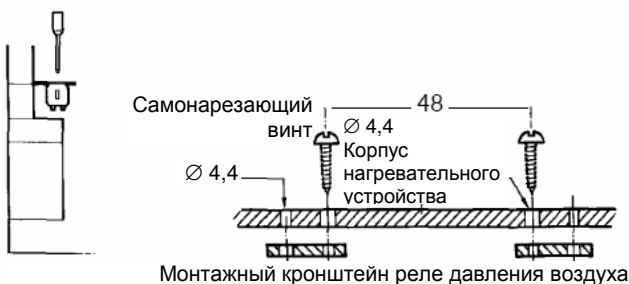
Рис. 9. Заднее крепление и монтажные размеры
